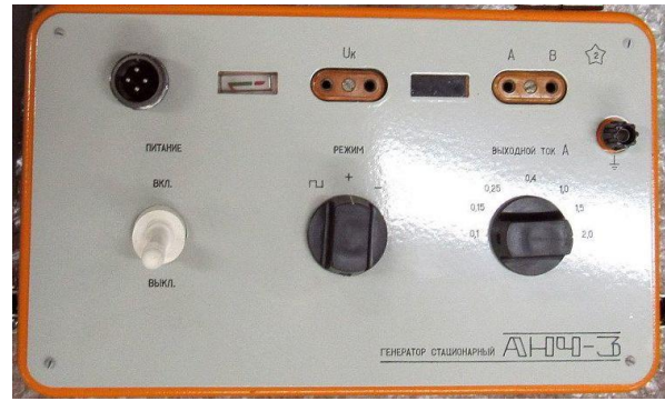
Рис.7.1.1. Комплект аппаратуры АНЧ-3. а-измеритель, б-генератор.
